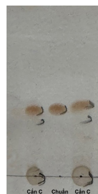
(b) Lựa chọn điều kiện tinh chế: bằng bản mỏng pha đảo RP18 và hệ pha động MeOH - H 2 O (20 : 80)
